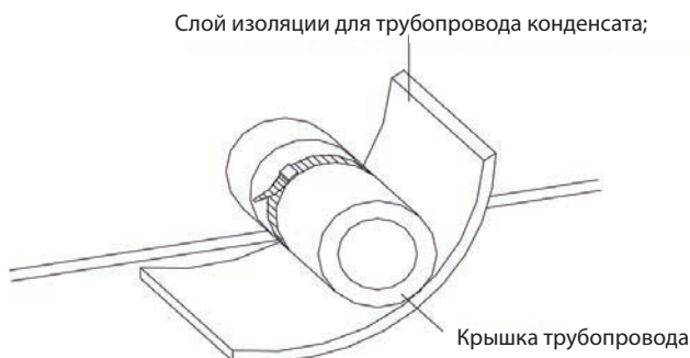
Рис. 13 Термическая изоляция трубопровода конденсата
